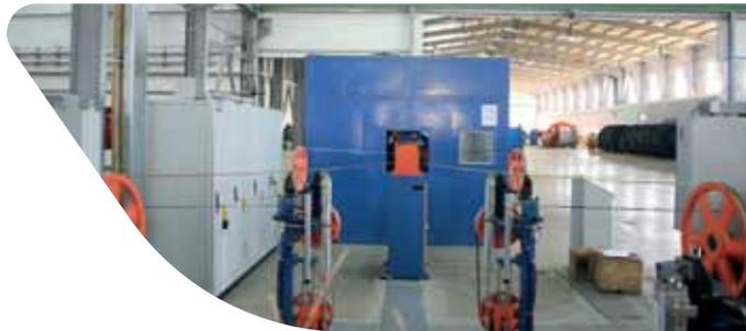
L'assemblage des phases consiste à regrouper différents conducteurs isolés afin de former un câble multi- polaire.
