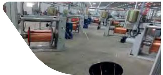
Après le tréfilage, les fils de cuivre recuit obtenus sont regroupés afin de former les conducteurs. Ce processus s'appelle câblage.
